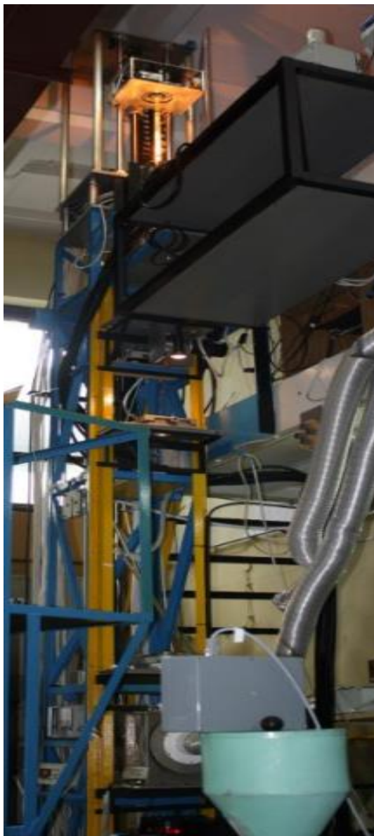
Рисунок 3.5 - Башня вытяжки оптического волокна и ее функциональная схема, лист 1
