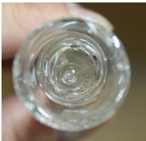
Рисунок 3.2 - Преформа подготовленная по методу MCVD в поперечном сечении
